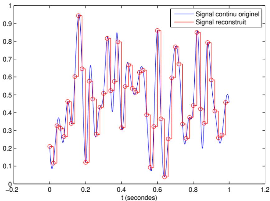
$F_e = 50$  Hz,  $T_e = 0.02$  secondes. Reconstruction de mauvaise qualité.
