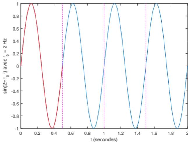
$$x(t) = \sin(2\pi f_0 t) \text{ avec } f_0 = 2 \text{ Hz}$$
