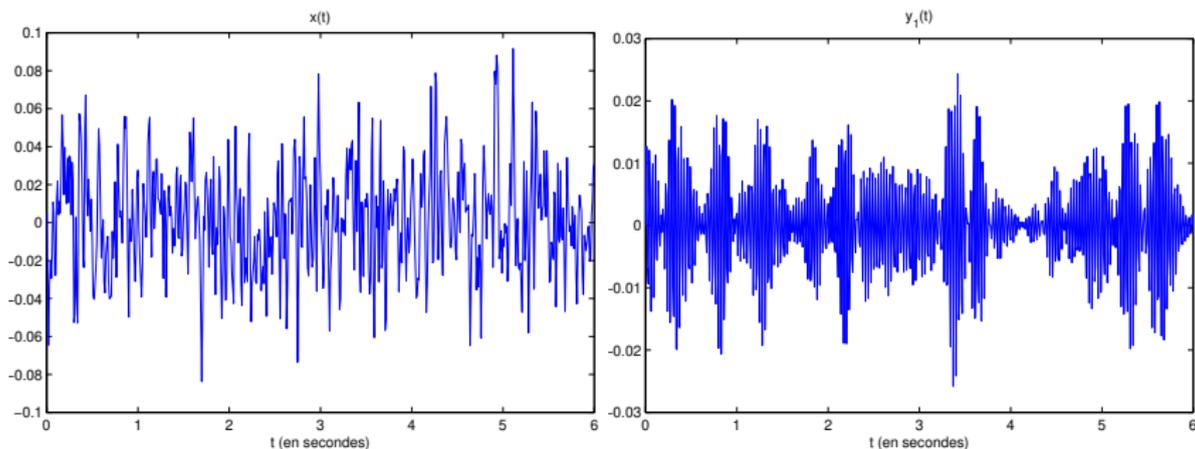
Le signal semble plus structuré : on a enlevé les basses fréquences et les hautes fréquences
