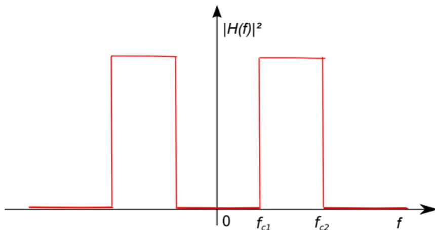
Fréquences de coupure :  $f_{c1}, f_{c2}$
