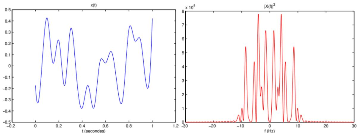
Signal lent : le module au carré  $|X(f)|^2$  est élevé dans les basses fréquences
