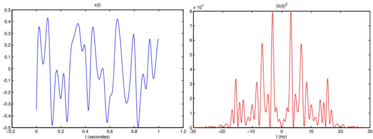
Signal plus rapide : le module au carré  $|X(f)|^2$  est élevé aussi dans les fréquences plus élevées
