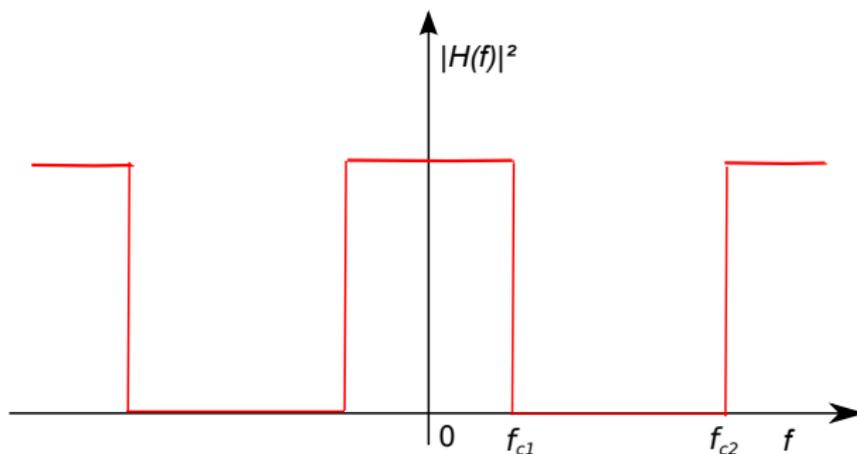
Fréquences de coupure :  $f_{c1}, f_{c2}$
