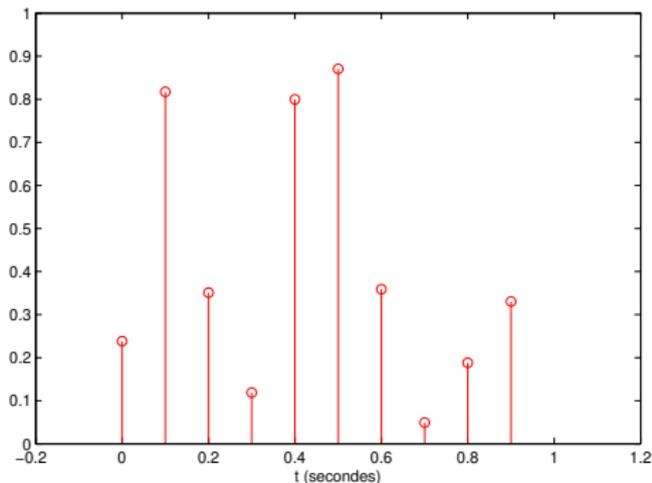
Le signal étudié ici varie de façon lente. On échantillonne le signal à  $F_e = 10$  Hz et on va essayer de reconstruire le signal à partir des seuls échantillons. Comment faire?
