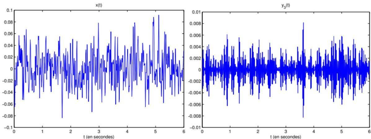
Le signal semble varier de façon plus rapide : on a enlevé les basses fréquences
